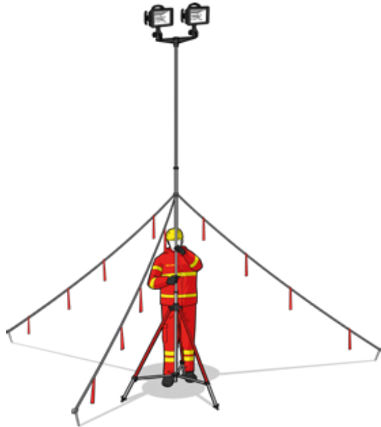
Abbildung: Sicherung von Flutlichtstrahlern
